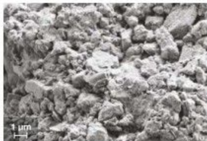
rys. Zdjęcie cząstki surowca do produkcji AtriGranu w powiększeniu pod mikroskopem elektronowym 5 tys. razy.
